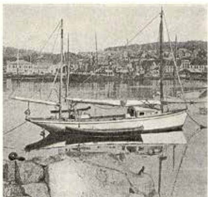
MOTORBAAD. Bygget af Archer af udsøgte Materialer, 32 Fod lang og forsynet med en 6 HK. Benzinmotor, Fart 4 Mil. Forer ogsaa Seil. Stor rummelig Kabyt. Pris Kr. 2.500.
