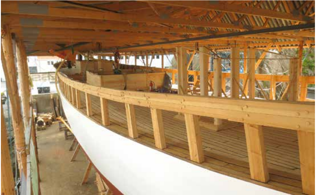
Dekk og rekkestøtter august 2015.
