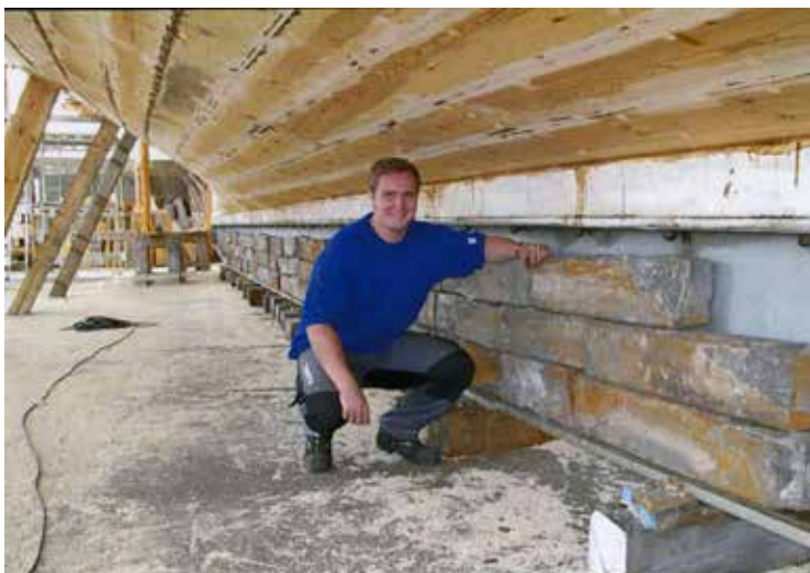
12 tonn anodestaver er lagt inn i jernbjelken som utgjør stråkjølen.
