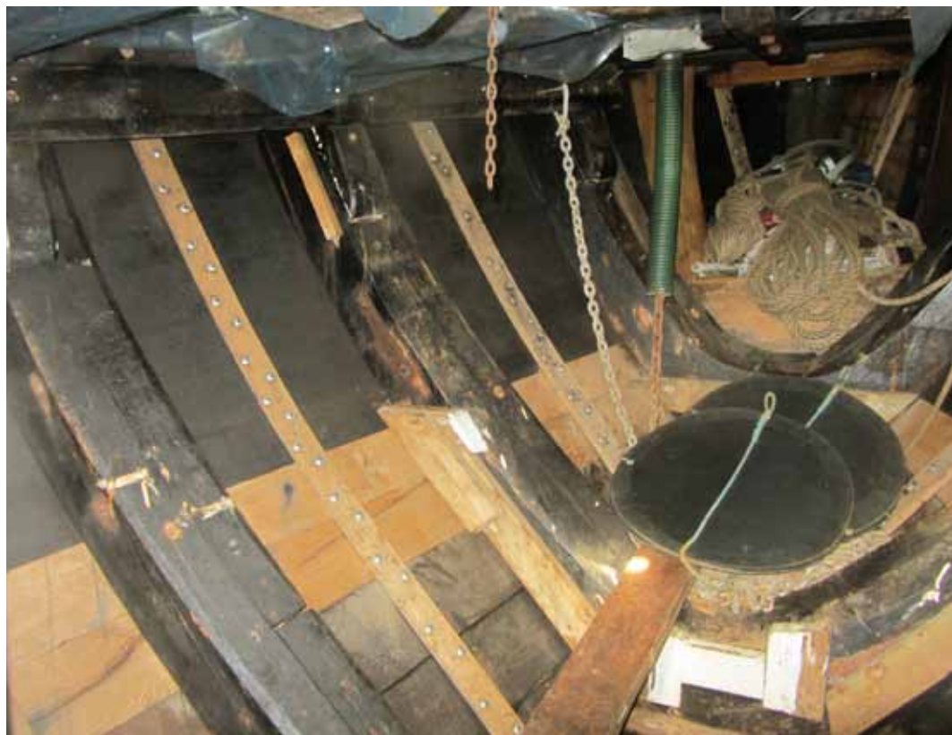
6 Nye remmer/ribber er på plass mellom spantene i forpiggen.
