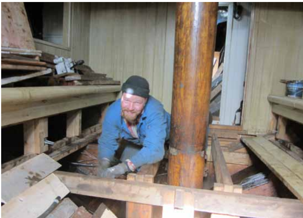
Glenn Helge legger på planblybarrene som utgjør ballasten.
