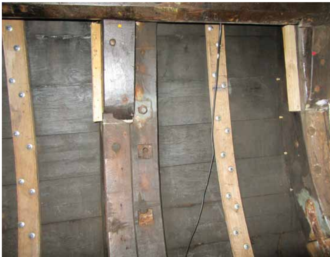
Remmene holder bordene tett sammen og er festet med galvaniserte jernnagler.
