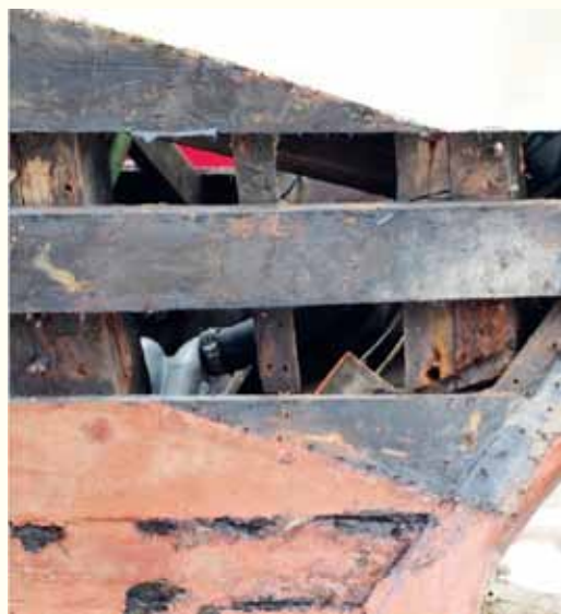
To dårlige bord i akterenden er fjernet.
